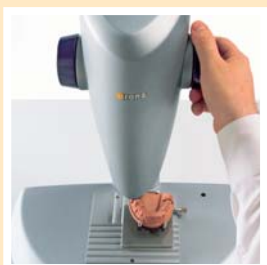
A szkennerek fej beállítása, és a beolvasás indítása
